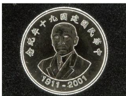
水平徑向環形光源照明效果
